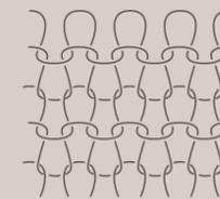
Das Walken ist ein Verfahren welches den Charakter des Stoffes am stärksten verändert. Ein gestrickter Schlauch bildet die Basis des Walkstoffes. Durch die Einwirkung von Feuchtigkeit, Wärme und Druck springt die Ware ein und erhält ein verschleiertes, filziges Aussehen. Im Vergleich zu Filz ist Walk dehnbarer und elastischer.
