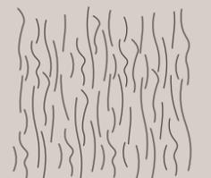
Der Filz besteht aus einzelnen Wollfasern die zu einem Vlies miteinander verbunden werden. Dafür wird das Faservlies in eine Richtung ausgerichtet und anschließend durch die Einwirkung von Feuchtigkeit, Wärme und Druck verfestigt. Filz ist robust, leicht und warm.
